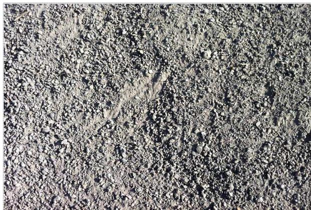
Fotografía 2. Árido reciclado de hormigón.
