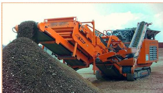
Fotografía 5. Planta móvil reciclaje de RCD
